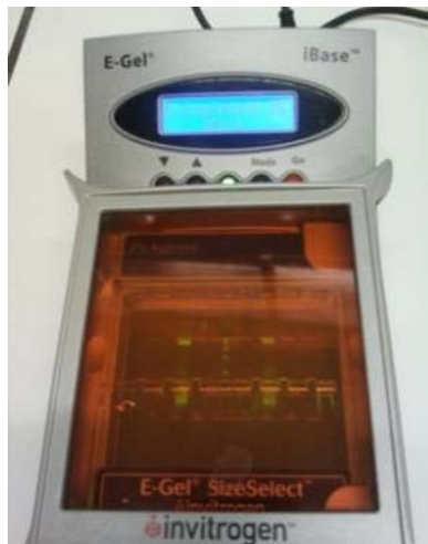
Figure 37 : Appareil E-gel sizeSelect contenant le e-gel pour effectuer la sélection des produits PCR sur la base de leur taille
