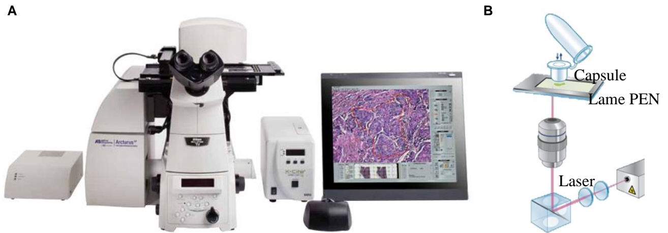
Figure 74. A. Appareil pour la Micro Dissection Laser B. Représentation de la méthode d'isolement
