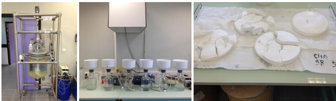
Figure 18 : synthèse d'hydroxyapatite stœchiométrique par précipitation aqueuse. Réacteur de synthèse (gauche), filtration (milieu) et obtention de produits bruts (droite).
