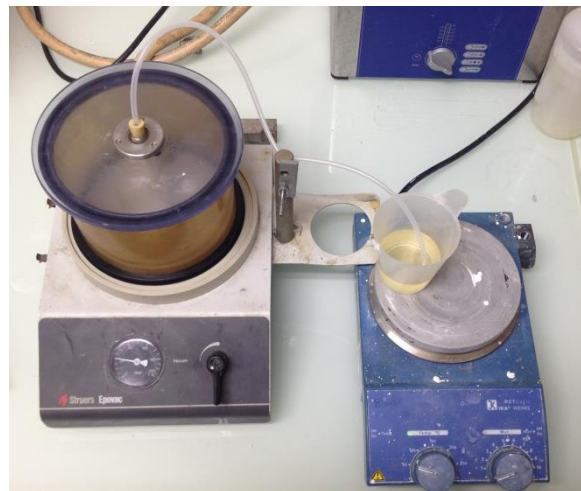
Figure 21 : imprégnation des céramiques par transfert sous vide (IT).
