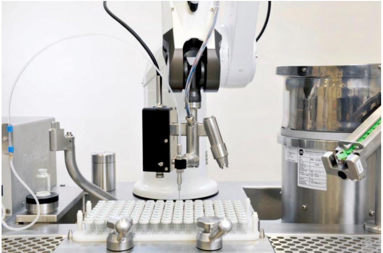
Figure 25 : Ligne automatisée de remplissage L1 Robot Line
