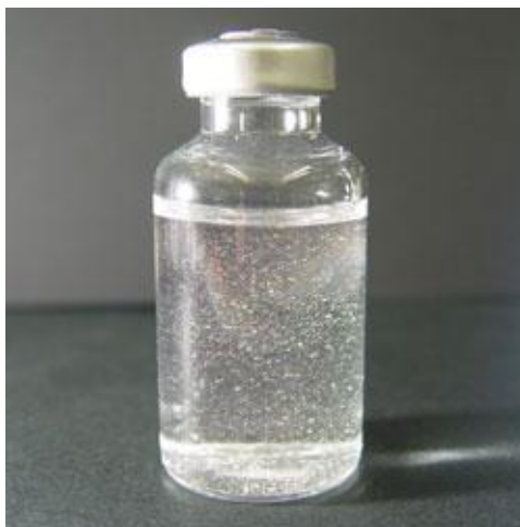
Figure 4 : Exemple d'un flacon en verre contenant une solution basique et sujet au phénomène de délamination
