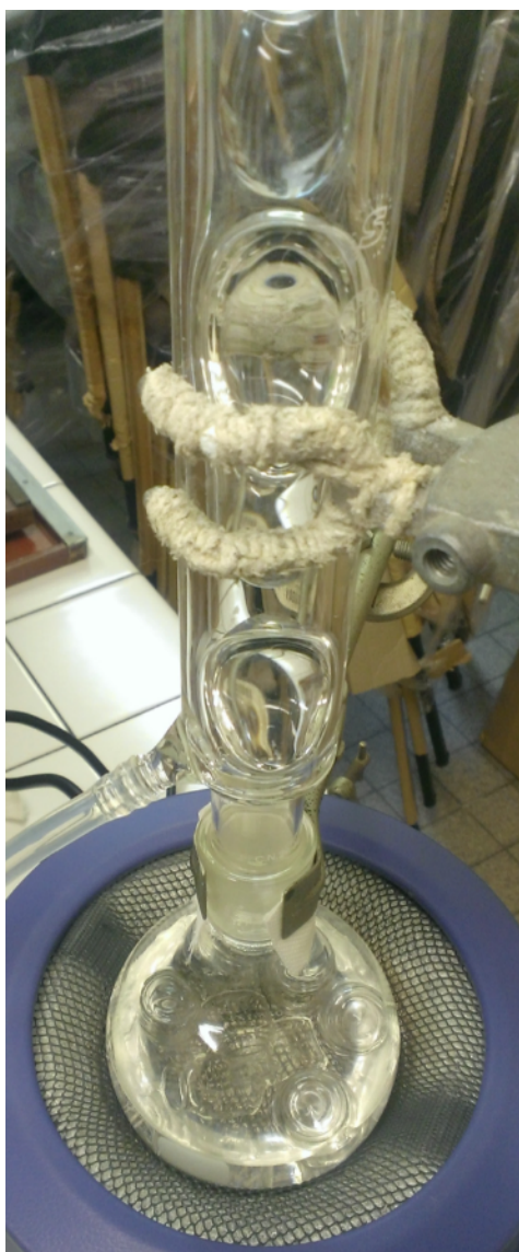
Figure 54 : Montage à reflux utilisé pour l'extraction des différents matériaux du flacon Crystal® (ici le corps en COC)
