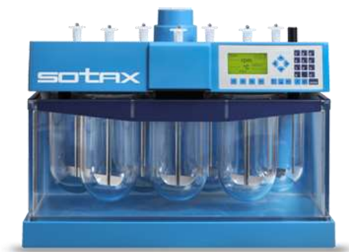
Figure 12 : Exemple d'un appareil à dissolution, le Sotax® (Sotax, n.d.).
