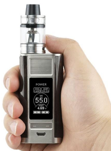
Figure 5. Cigarette électronique de 4 ème génération, ici avec une forme de boîtier ( http://www.smokstore.us/Joyetech-Cuboid-Tap-Vape-Box-Mod-Starter-Kit )
