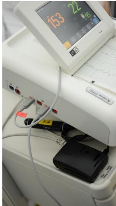
Figure 24 : Installation du Raspberry Pi sur le moniteur cardiaque de type Philips® Avalon FM30.
