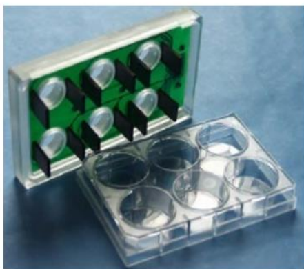
Figure 34 : Dispositif d'électrostimulation cellulaire (Dish, IonOptix, Dublin, Irlande). Montage expérimental du système de contraction des myotubes C2C12. Une (A) plaque à 6 puits contenant une paire d'électrodes de carbone pour chaque puits a été connectée à un (B) générateur d'impulsion électrique.
