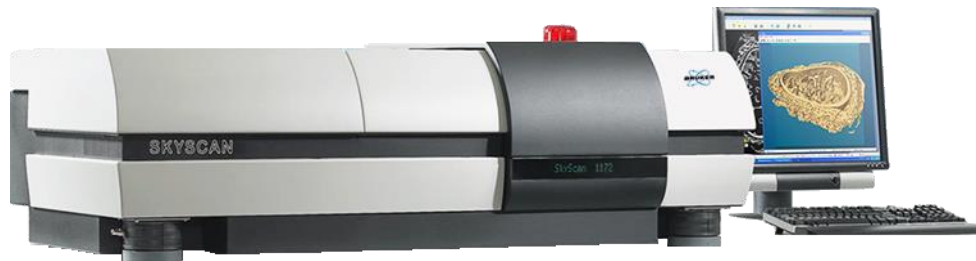
Figure 31 Microtomographie à rayons X Skyscan 1172 (Bruker mCT, Kontich, Belgique).
