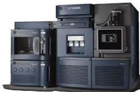
Figure 13 : Spectromètre de masse : CL-SM/SM XEVO TQ-S (source : [www.waters.com](http://www.waters.com), consulté le 20/07/2022)
