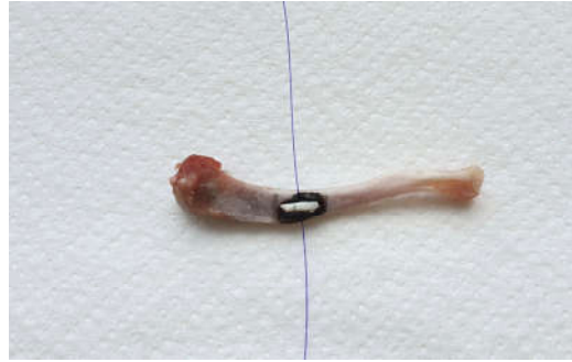
Figure 4 : Segment de fibula de 6 mm de long collé sur la diaphyse tibiale avec interposition d'un fil de Vicryl® permettant le test mécanique par traction
