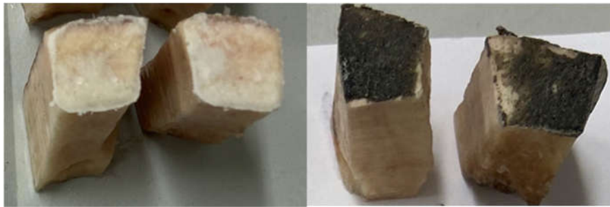
Figure 17 : Faciès de rupture d'un collage d'échantillons en titane par TTCP/OPS à gauche et TTCP/OPS-nPDA à droite après 24 heures d'immersion dans un bain de PBS à 37°C montrant un mode de rupture cohésif
