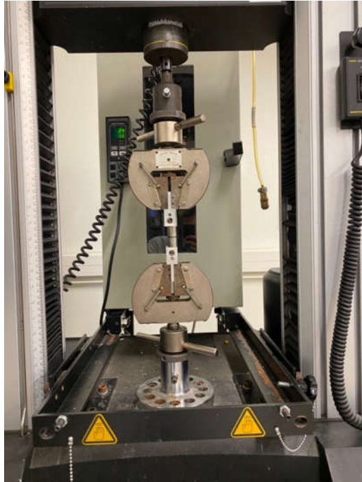
Figure 3 : Test mécanique de traction uniaxiale avec cylindres de titanes collés en cours sur un extensomètre Instron® 4466
