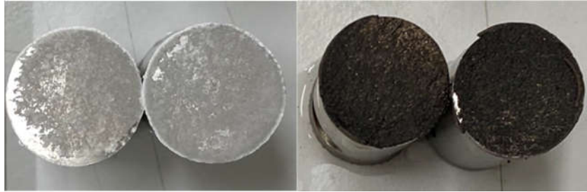
Figure 15 : Faciès de rupture d'un collage d'échantillons en titane par TTCP/OPS à gauche et TTCP/OPS-nPDA à droite après 24 heures d'immersion dans un bain de PBS à 37°C montrant un mode de rupture cohésif
