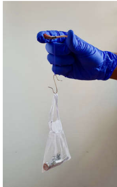
Figure 5 : Test de traction ex vivo d'un segment de fibula collé sur un tibia de rat avec mise en charge progressive par des poids standardisés
