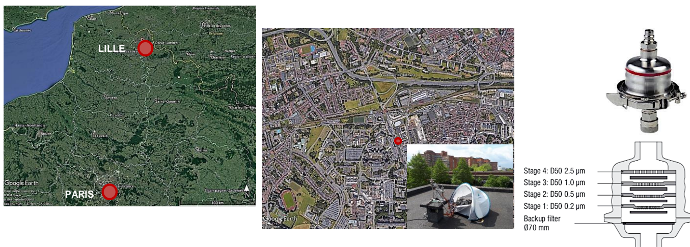
Figure 39 : Site de prélèvements des particules ultrafines et impacteurs en cascade à haut-débit Dekati DGI-1570.
