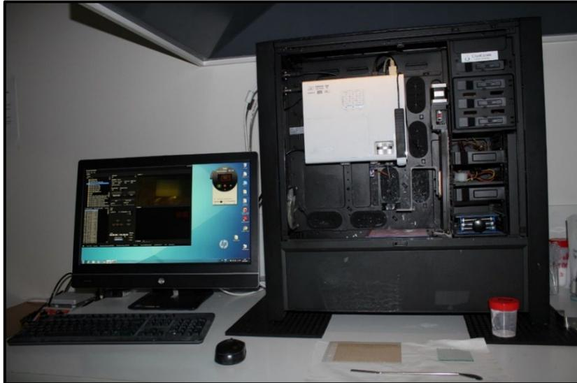
Figure 7 : logiciel gérant la mise en forme par SLA sur l'ordinateur (à gauche) (CryoCeram®, CryoBeryl Software®) et à la machine de mise en forme (à droite) (CryoCeram Printer®, CryoBeryl Software®).
