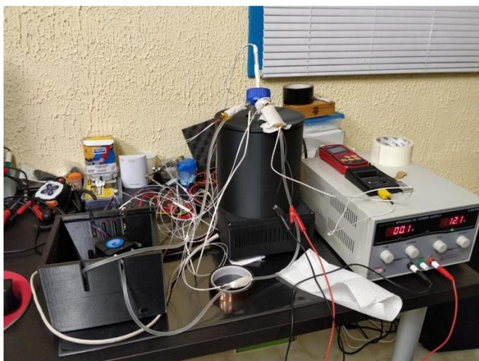
Figure 43. Montage ayant servi à la calibration du module de chauffage et d'homogénéisation
