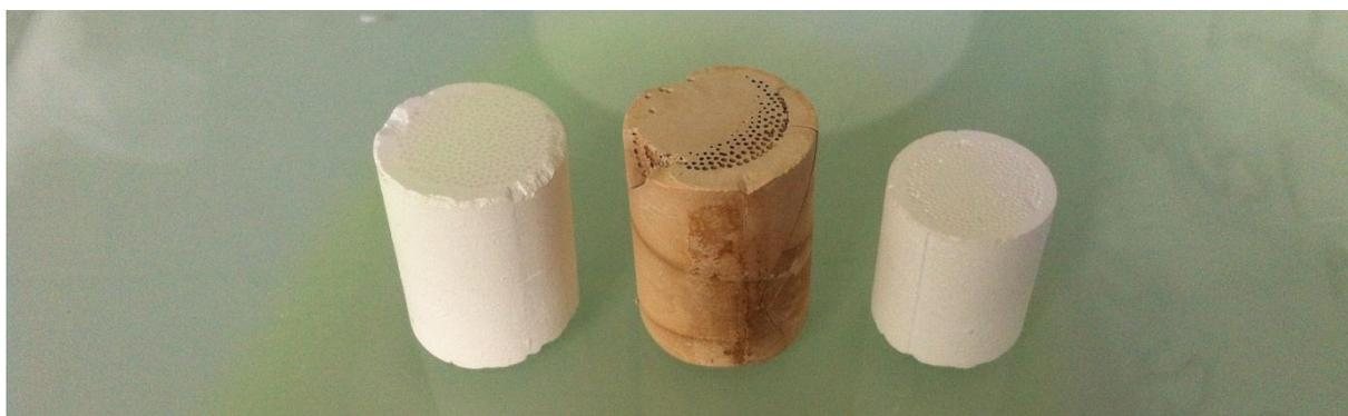
Figure 19. De gauche à droite, aspect d'une pièce à cru, d'une pièce après déliantage et d'une pièce après frittage
