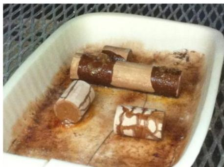
**Figure 66. Matrices en fin de phase de déliantage. On note les fissures des parois microporeuses par lequel le polyméthacrylate de méthyle se déverse.**
