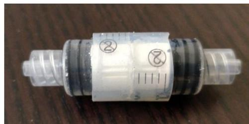
Figure 37. Montage du noyau du bioréacteur composé de 2 seringues de 5ml reliée par une tubulure silicone afin d'assurer son étanchéité
