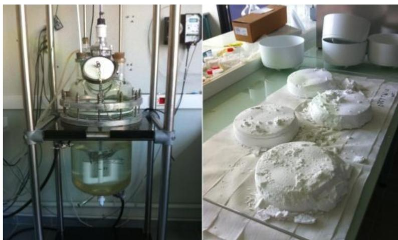
Figure 24. Réacteur de synthèse par voie aqueuse de poudres phosphocalciques et pains de poudre
