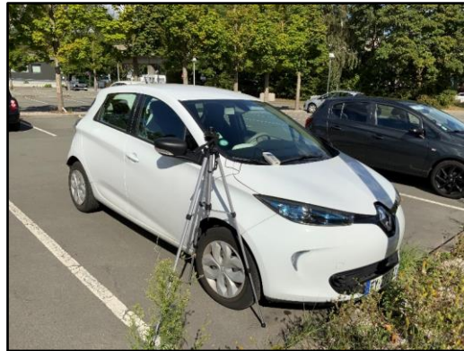
Fig. II.29 : Test du sous-système CVCA en extérieur en mode climatisation.
