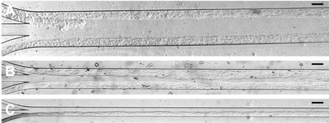
Figure 3-18 Structures de collagène obtenues avec les différentes tailles de canal central, A : W = 600\mu\text{m} , B : W = 300\mu\text{m} , C : W = 150\mu\text{m} , barre = 200\mu\text{m}
