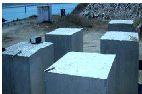
Figure I.30. Blocs de béton à base de sédiment ([56])
