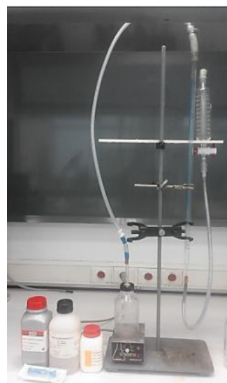
Figure II. 11 Schéma et montage de Calcimètre de Bernard
