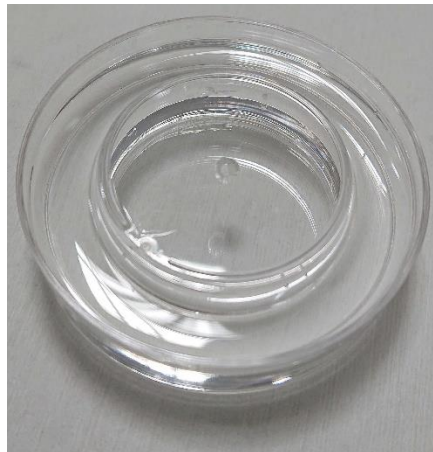
Figure 3-16 : Puits de culture en PDMS. Il est moulé à l'aide de deux boîtes de Pétri de 60mm et 35mm de diamètre
