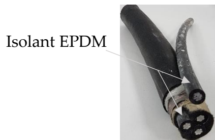
Figure II-1. Câble électrique haute tension
