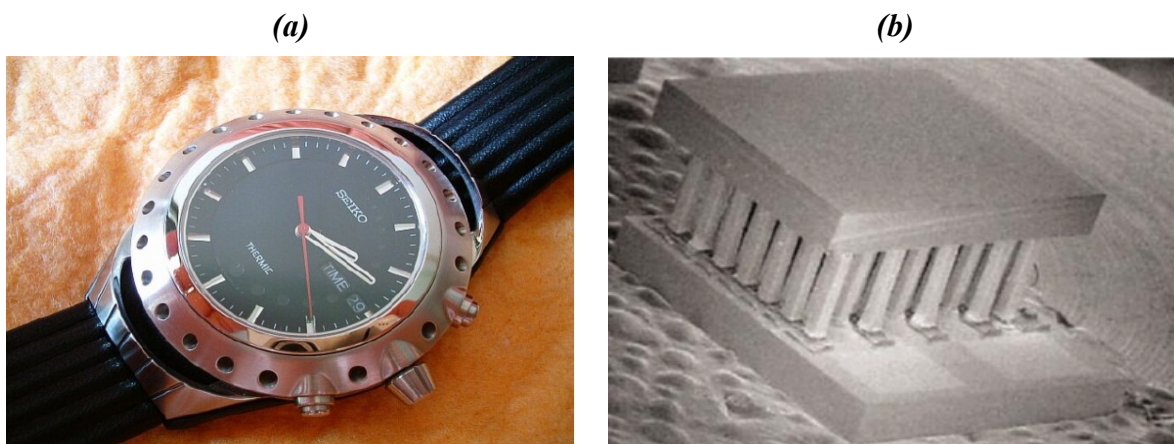
Figure 1.22 : (a) Photographie de la montre TE développée par Seiko en 1998, (b) Image par microscopie électronique à balayage du \mu TEG vertical intégré dans la montre [88].
