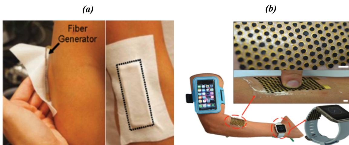
Figure 1.11 : (a) Image d'un textile piézoélectrique fixé sur le coude humain [50], (b) Image de certains dispositifs électroniques fixés sur la peau humaine [51].
