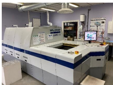
Figure II.15 Fabrication des films minces de polyéthylène (PE) par la technique de bi-étirage. Image du (a) Brücker CARO IV et (b) du système de prise en pince de l'échantillon (Laboratoire UMET, Université de Lille).
