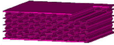
FIGURE 1.17 – Schéma d'un revêtement composé de cellules élémentaires alvéolaires avec un coefficient de Poisson négatif.
