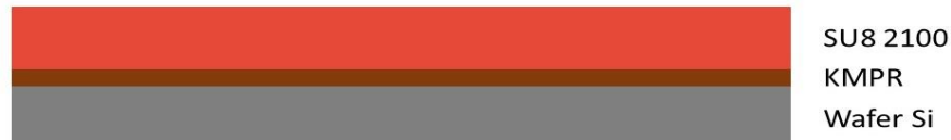
Figure 48 : Etape d'enrobage avec de la résine SU8 2100.
