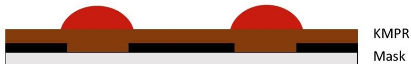
Figure 60 : Etape de développement de la résine SU8 2100 photolithographiée par lithographie diffuse via le développeur SU8.
