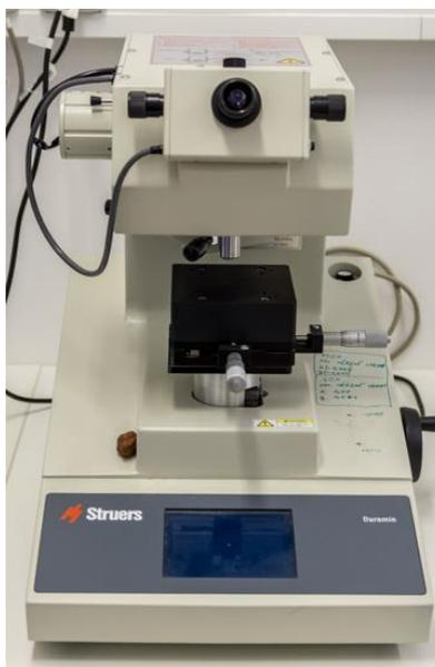
Figure 2-12: Le duromètre « DURAMIN ».
