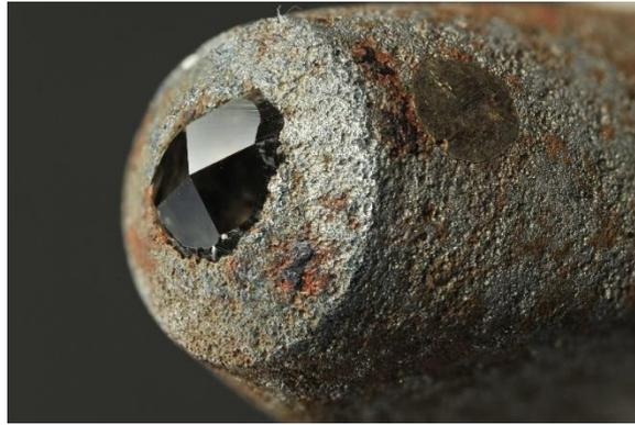
Figure 1-18 : Forme géométrique d'une pointe Vickers.
