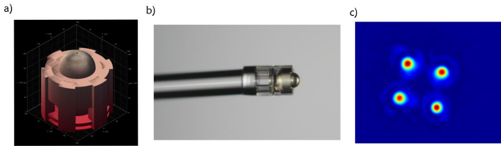
Figure 3.24. a) Fichier d'impression de la lentille best form. b) Fibre équipée de la lentille imprimée. c) Spots obtenus à la caméra dans le cas d'une excitation non sélective en entrée
