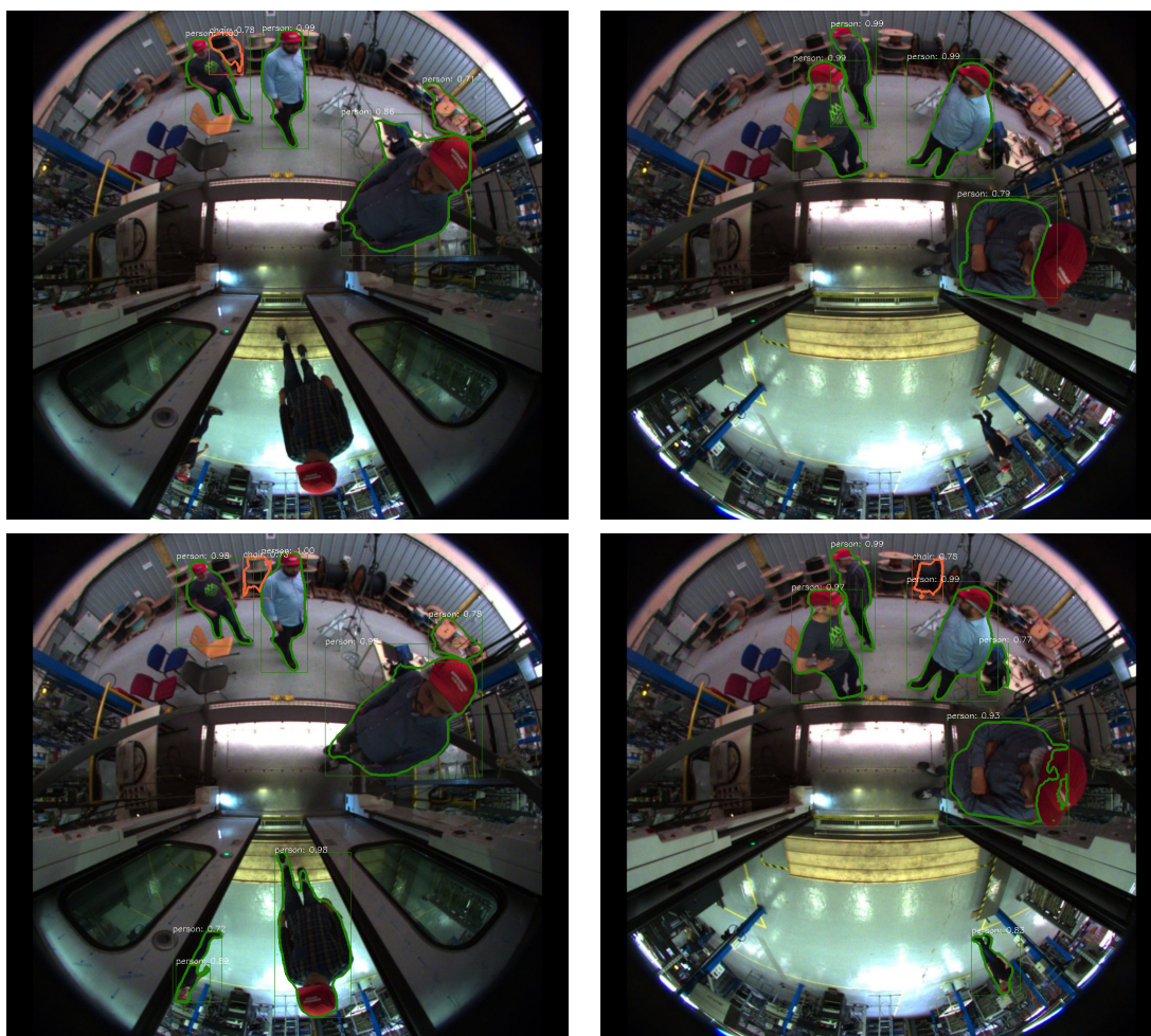
FIGURE 3.12 – Première ligne : résultats d'inférence avec Mask R-CNN ResNet-101. Deuxième ligne : résultats d'inférence avec Mask R-CNN ResNet-101 avec augmentation 35FE.
