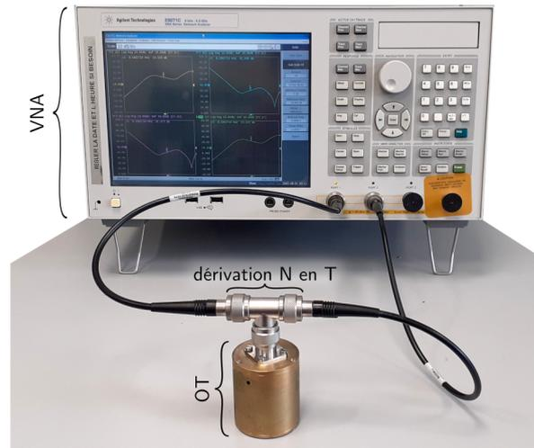
FIGURE 2.15 – Photographie du dispositif OT branché sur le VNA en mesure de type parallèle.
