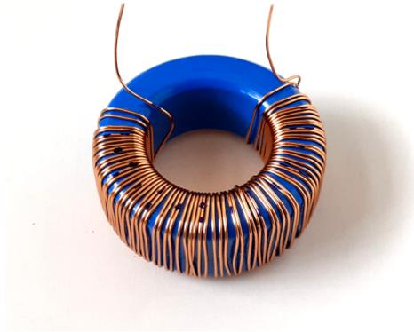
FIGURE 2.33 – Photographie du noyau  $T_3$  mm bobiné.
