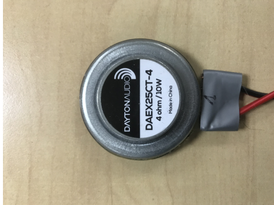
FIGURE D.1 – Vibreur posé sur une table en bois, en position pour le calcul de l'impédance.
