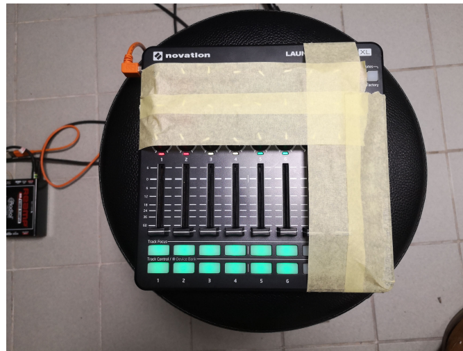
FIGURE 7.2 – L’interface MIDI utilisée pendant l’expérience. De gauche à droite, les colonnes 1-2, 3-4 contrôlent respectivement le retour audio et le retour vibrotactile. Les curseurs 1 et 3 contrôlent le volume de sortie et les curseurs 2 et 4 contrôlent la quantité d’effet du retour audio et du retour vibrotactile, respectivement. Les boutons situés sous les curseurs activent et désactivent chaque retour, devenant respectivement verts et rouges.
