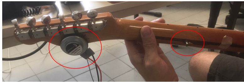
FIGURE 6.2 – Positions, indiquées par les cercles rouges, du vibreur et de l'accéléromètre pendant l'étape de mesure.
