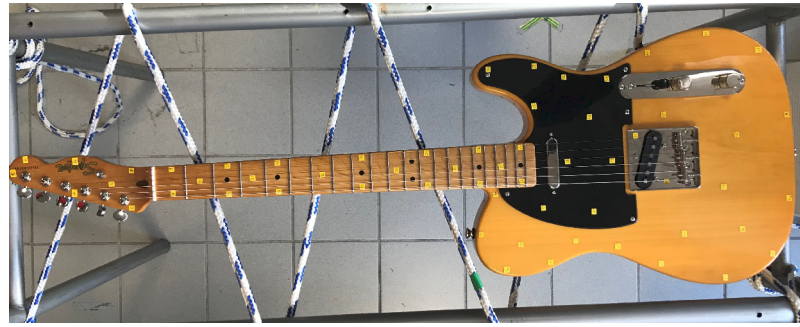
FIGURE F.1 – Installation pour l’analyse modale. Les carrés jaunes représentent les 59 points de frappe pour les mesures.
