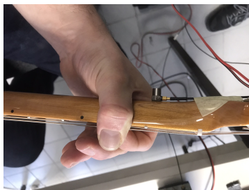
FIGURE F.7 – (suite) Position de la main de chaque participant tenant le manche et fonction de transfert mesurée pour l'expérience présentée au chapitre 5.
