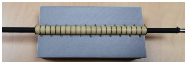
FIGURE 2.18 – Étape d'assemblage des électrodes et anneaux piézoélectriques sur la tige filetée.
