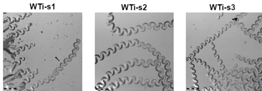
FIGURE 2.6 – Images des boucles formées sur trois couches de WTi (250 nm d'épaisseur), elles-mêmes déposées sur du silicium (image obtenue par microscopie confocale à balayage laser).
