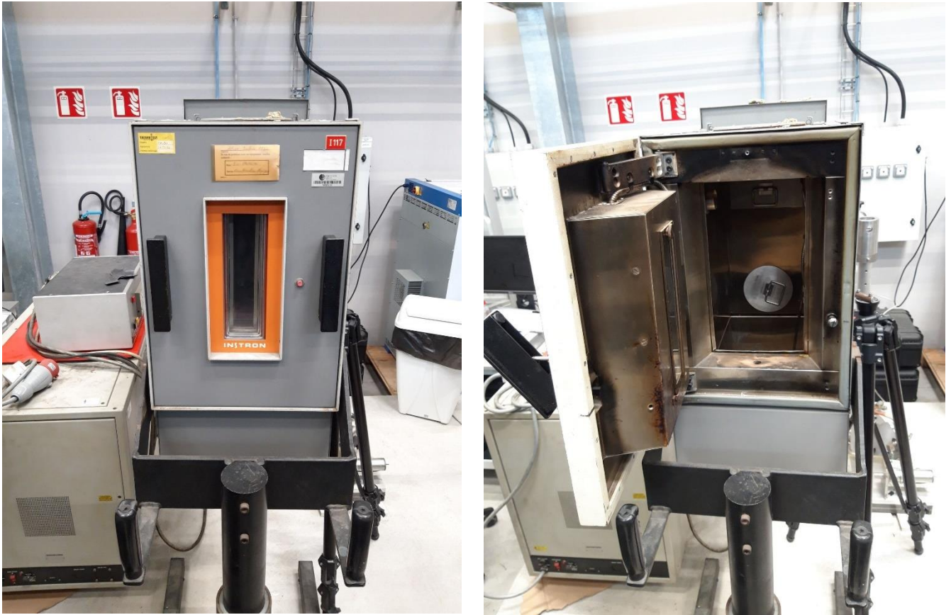
Fig.VI.4 : Enceinte thermique Instron 1198® pour les essais de fatigue à température contrôlée
