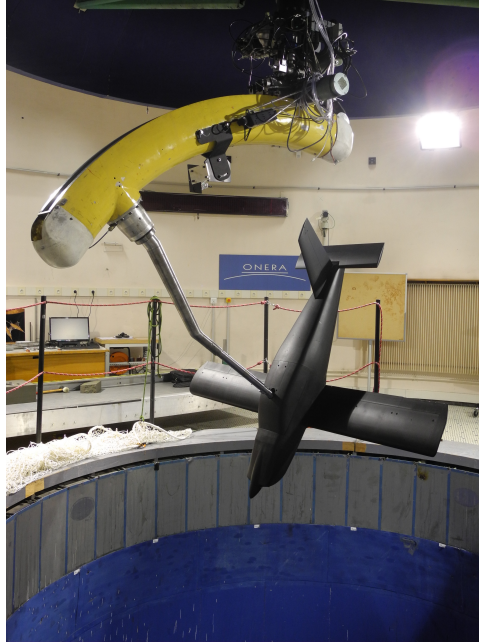
FIGURE 4 – Photographie de la maquette d’avion léger montée sur la balance rotative de l’Onera Lille. ©Onera
