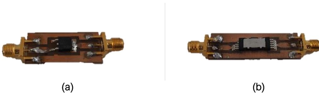
Figure II.22 – Diodes SiC et leurs dispositifs de caractérisations associés (a) STPSC8Ho65BD (b) IDDDo4G65C6XTMA1
