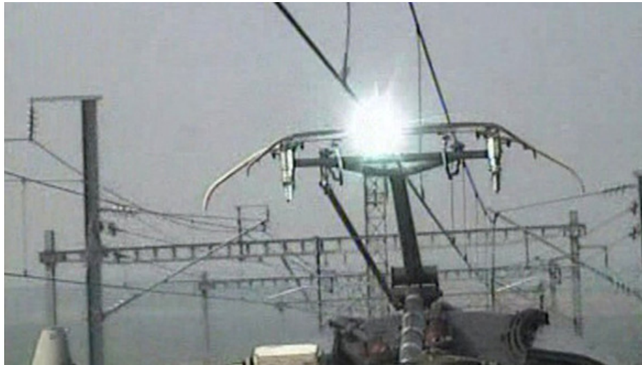
FIGURE 2.1 – décharge électrostatique caténaire/pantographe TGV
