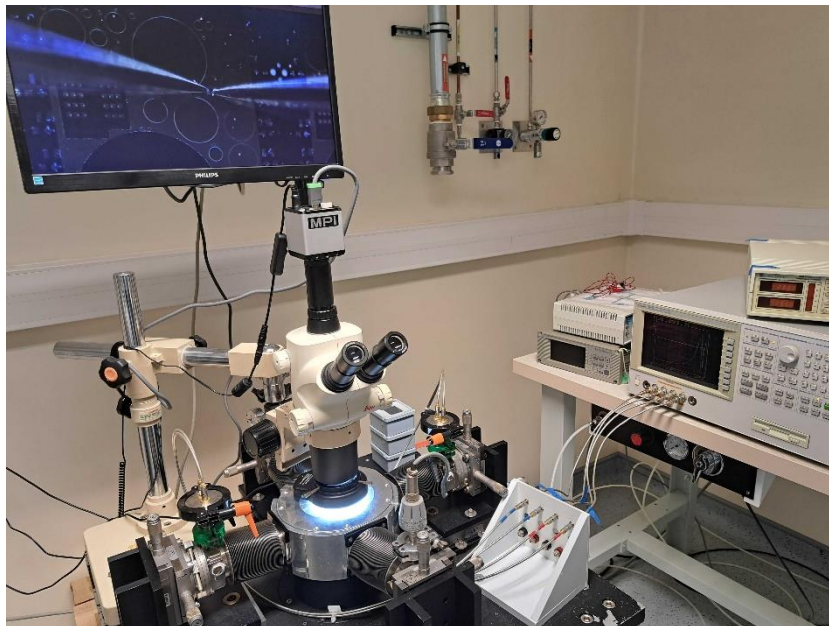
Figure 3.20 : Station sous pointes et impédancemètre pour caractérisations C-V.
