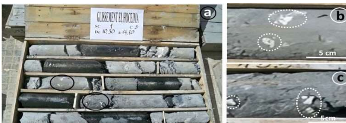
Figure 34 : (a) En cercle noir brèche mécanique monogénique hétérométrique. (b) Clastes anguleux de la même origine de taille pluri centimétrique. (c) clastes de la même origine de taille centimétrique plus ou moins cohésifs soutenus par une matrice.
