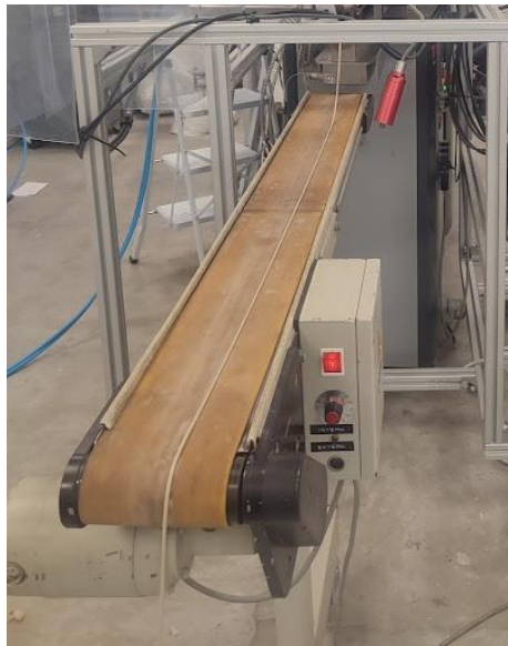
Figure II.14. Système d'avancement du filament.
