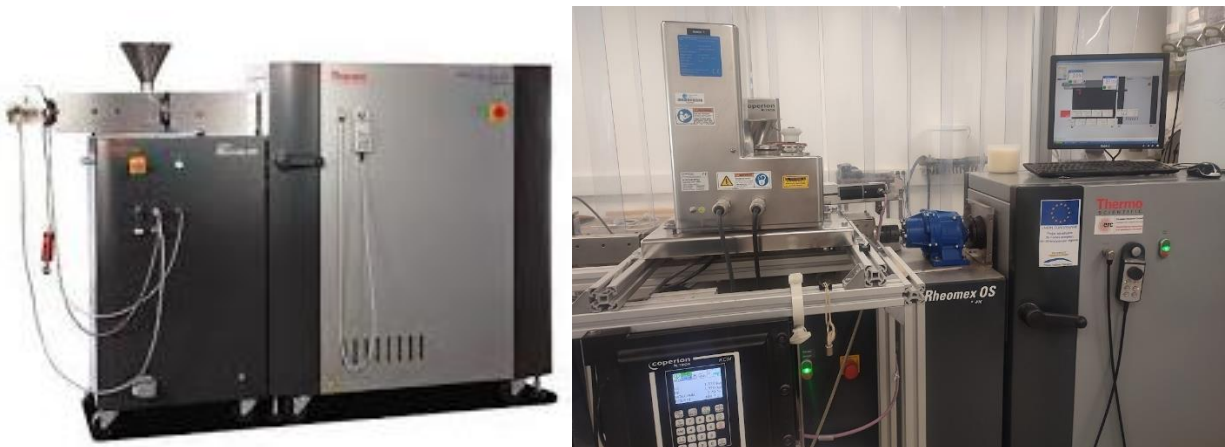
Figure II.9. Extrudeuse à double vis HAAKE Rheomex OS PTW 16.
