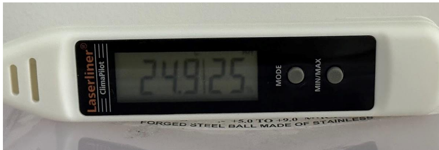
Figure II.17. Valeur d'humidité enregistré par hygromètre (Laserliner).
