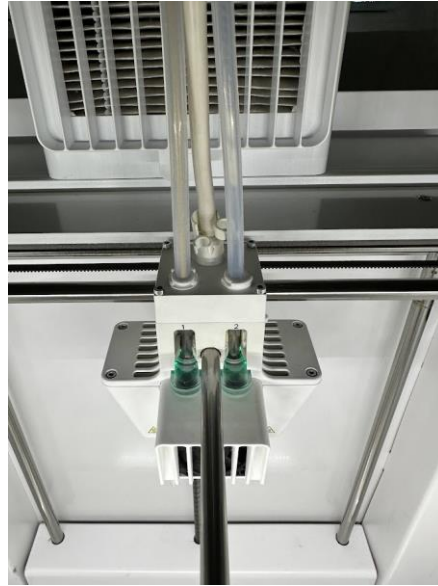
Figure I.46. Impression de composites selon la méthode b (mélange de filaments) : image réelle d'une imprimante à deux extrudeuses (marque ULTIMAKER 3D printer).
