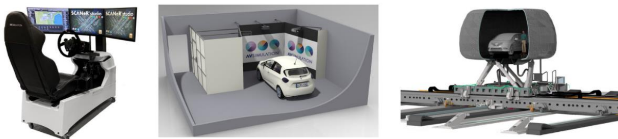
Figure 23: les trois grandes classes de simulateur de conduite
