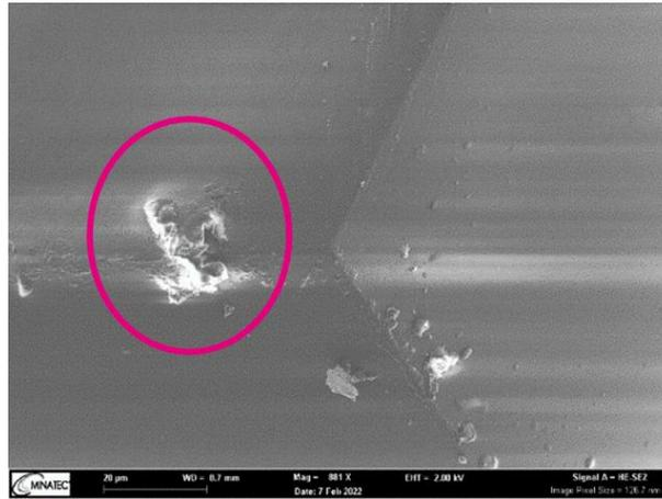
Figure 73 Image SEM top-view de l'extrémité de la pointe Berkovich après des essais d'indentation dans la résine. Des résidus sont observés.
