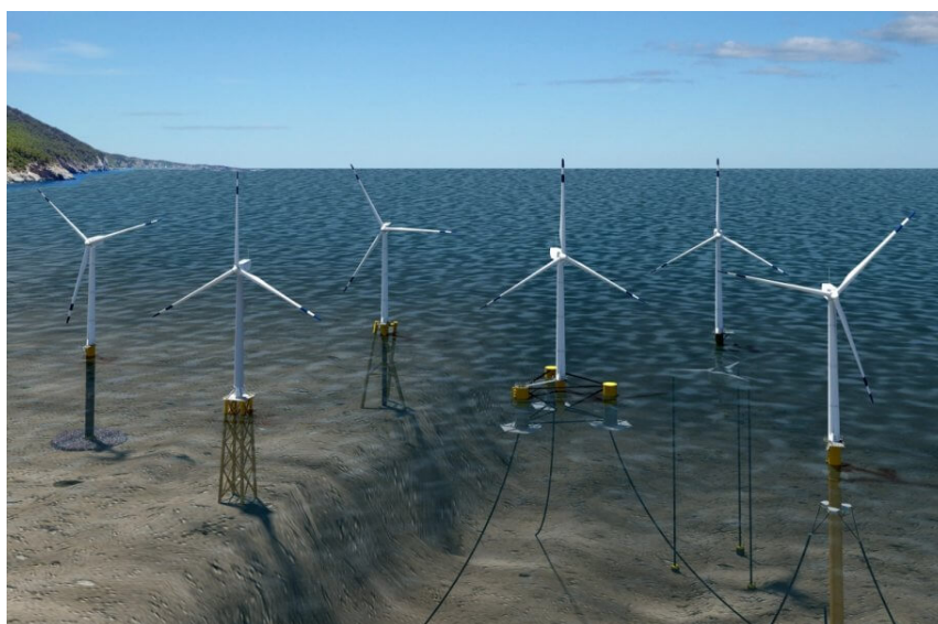
FIGURE 1.2 – Eoliennes en mer fixes (les trois premières) et flottantes (les trois dernières), [10]
