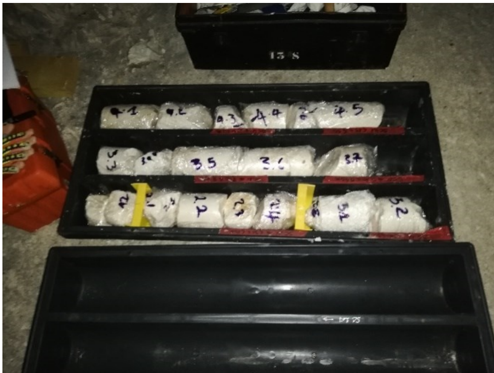
Figure 3.2 Carottes prélevées in-situ
