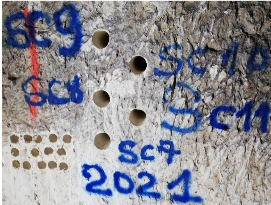
Figure 3.1 Forages réalisés lors des deux campagnes de prélèvement : la première campagne à gauche et la deuxième à droite avec un diamètre plus grand
