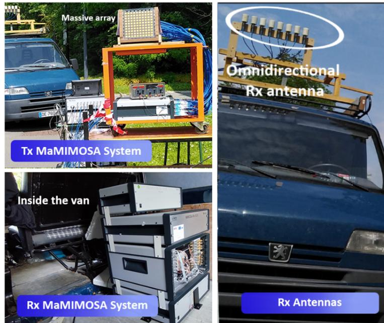
FIGURE 2.13 – Sondeur MaMIMOSA Tx et Rx, le réseau d’antennes massif en émission et un réseau ULA en réception.
