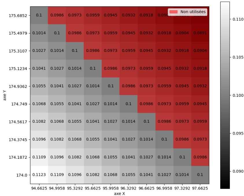
FIGURE 4.8 – Evolution de la taille de grains dans le chanfrein du domaine A
