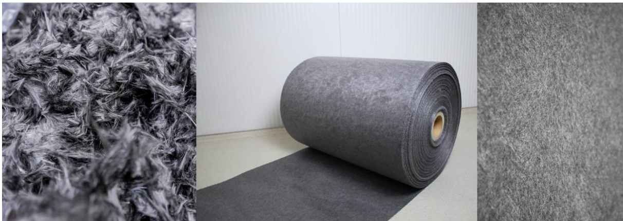
Figure 1.8 : Formation du non-tissé par voie humide (milieu) à partir de fibres de carbone recyclées discontinues (gauche) [68]
