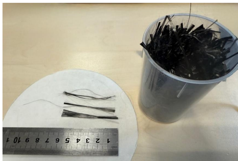
Figure 2.1 : Faisceaux de fibres extraits du lot initial de fibres de carbone recyclées non ouvertes (NO)
