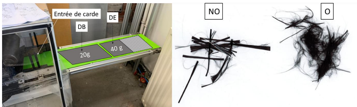
Figure 3.1 : Différence entre DB et DE sur le tapis d'alimentation de la carde (gauche), et les différents niveaux d'ouvroison (droite)
