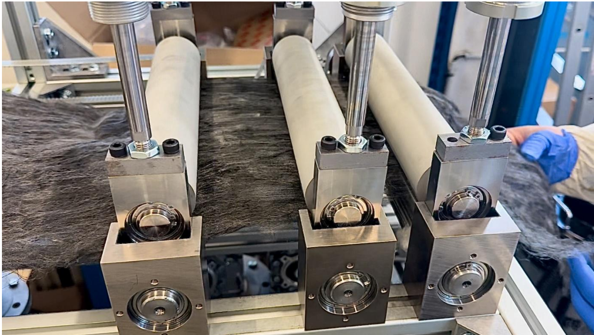
Figure 1.17 : Tête d'étirage du banc d'étirage expérimental avec un voile de fibres de carbone recyclées en mélange avec du PP
