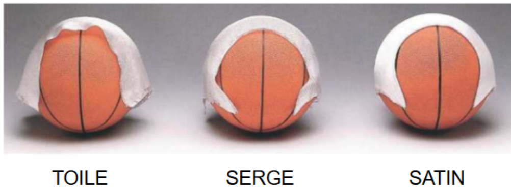
Figure 14 - Comparaison de la capacité des familles de tissus à se mettre en forme en fonction de leur module de cisaillement. [45]
