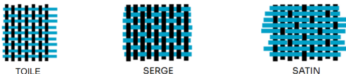
Figure 38 - Schémas des armures fondamentales de tissage.
