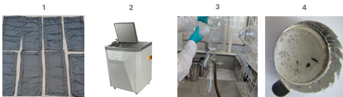
Figure 50 - Étapes de la simulation de lavage standardisé selon la méthode TMC pour quantifier le relargage de FFMP.
