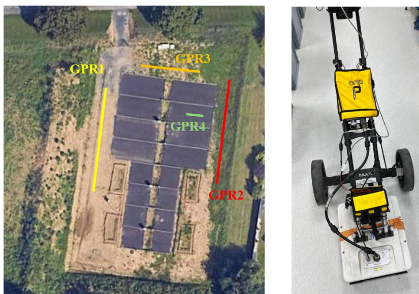
Figure 92 : Positionnement des scans GPR (Géoradar IDS TR 400 MHz) sur le site ETAGEP
