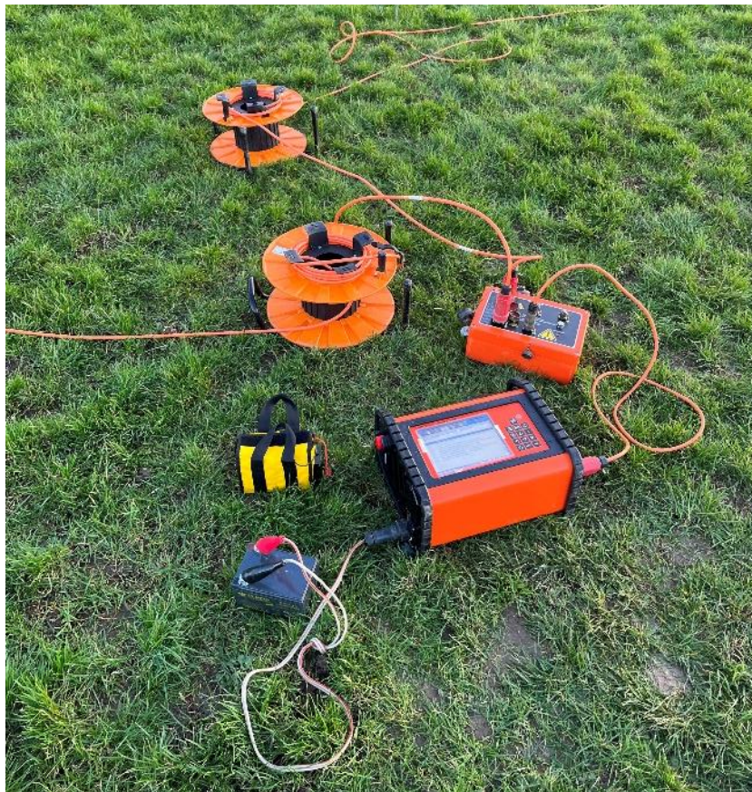
Figure 82 : Résistivimètre Terrameter LS connecté au boîtier ES1064C
