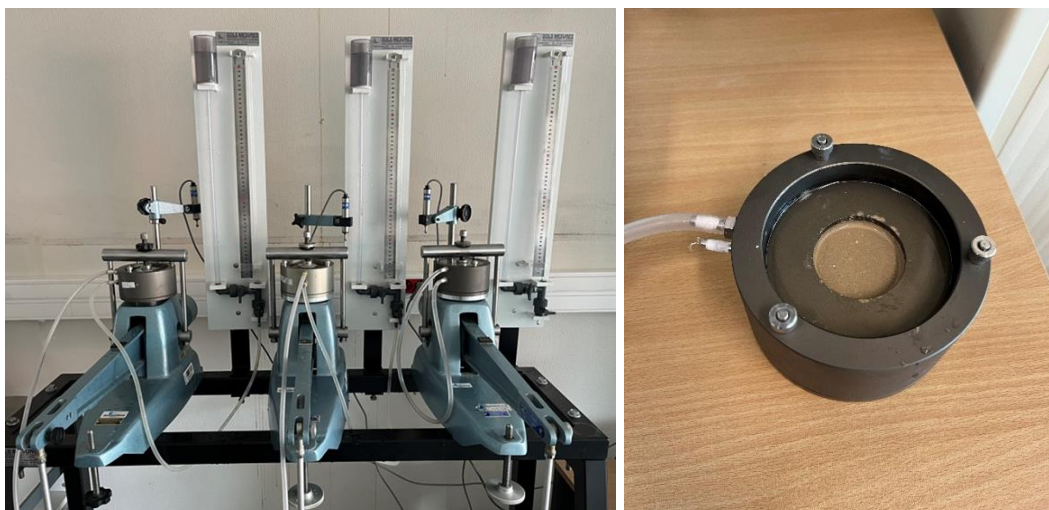
Figure 86 : Cellules œdométriques ayant servi pour l'évaluation de la perméabilité en laboratoire
