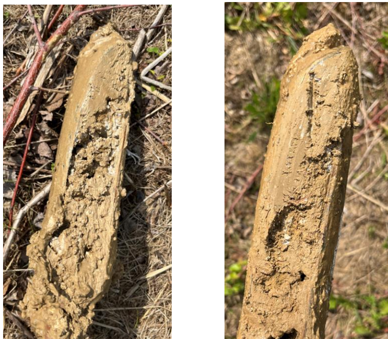
Figure 20 : Carottages réalisés à la tarière, présence de granules de craie dans l'horizon limoneux (à partir de 2 m de profondeur), Cité Scientifique, Université de Lille
