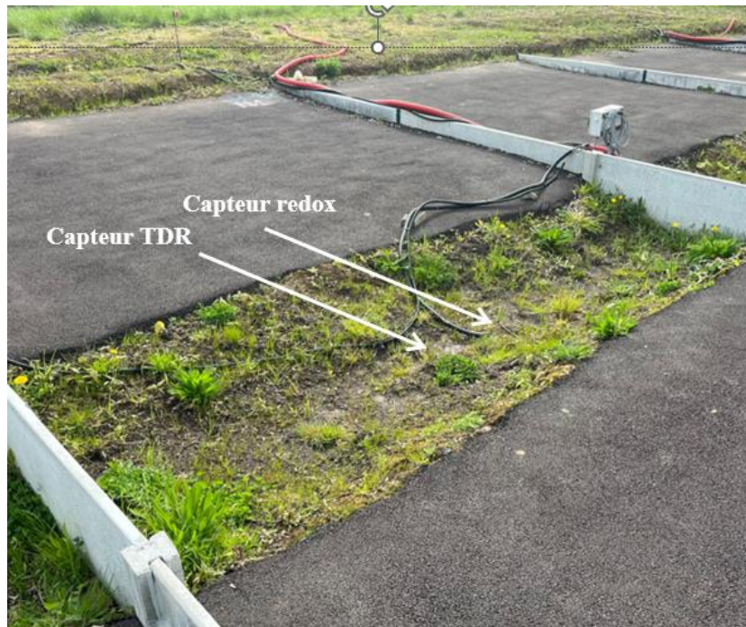
Figure 34 : Positionnement des capteurs GroPoint (teneur en eau) et ORP (Redox)
