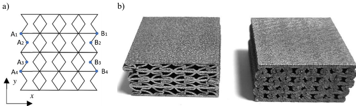
Figure 1.9 : Représentation d'une structure auxétique hexagonale rentrante à déformation stable (a), structure déformée avec parois fines à gauche et épaisses à droite (b). [27]
