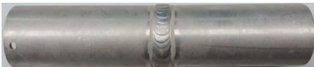
Figure 96 : Eprouvettes utilisées pour les essais de fatigue constituée de deux tubes soudés bout à bout.
