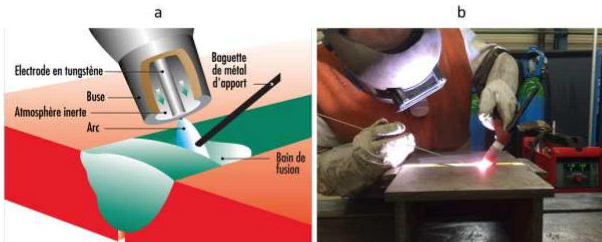
Figure 6 : (a) Schéma de principe du soudage TIG et (b) exemple de réalisation d'un cordon.
