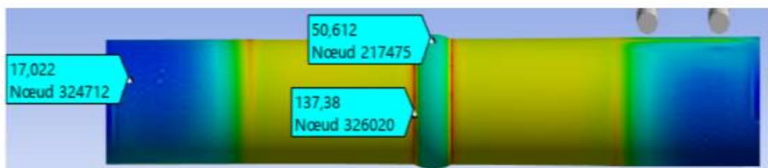
Figure 101 : Répartition des contraintes équivalentes de von Mises (en MPa) sur l'éprouvette
