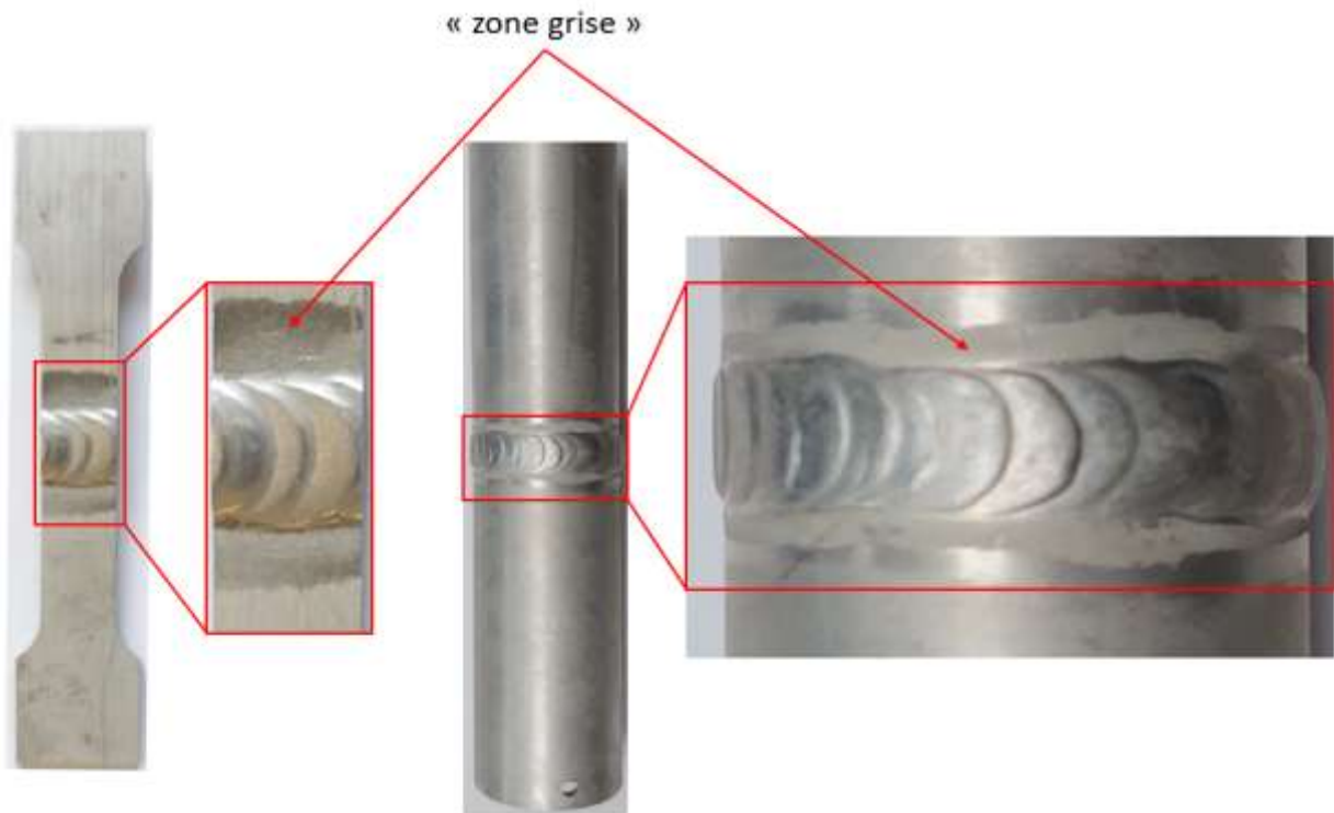
Figure 26 : Différence d'aspect en surface autour des cordons de soudure.
