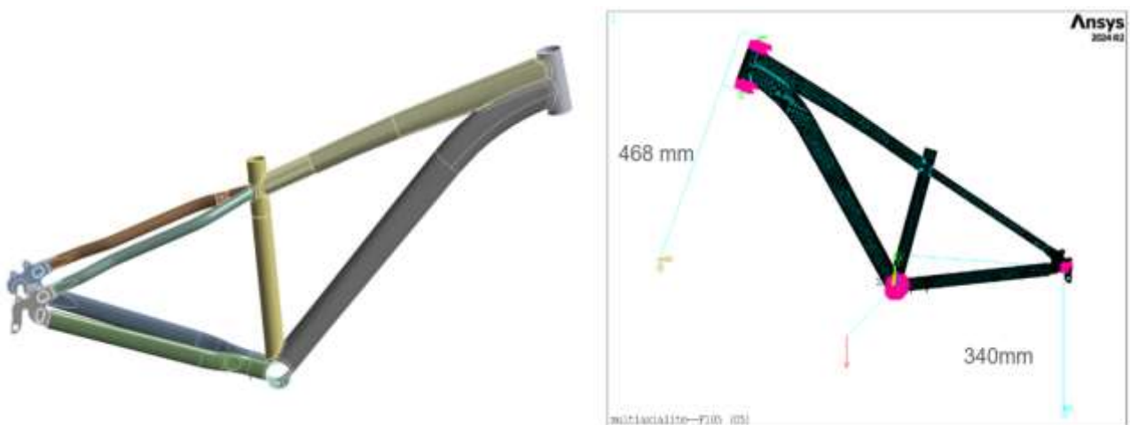
Figure 15 : Géométrie du cadre choisi et visualisation des conditions aux limites de la simulation
