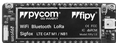
FIGURE 5.1 – Illustration d'un module FiPy de Pycom [84], disposant de six technologies de communication sans fil.
