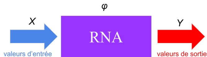
FIGURE 2.2 – Algorithme des réseaux de neurones, prennent un ensemble de valeurs X renvoie un ensemble de valeurs Y , les valeurs étant encodées d'une certaine manière. La "fonction" \varphi définit la manière dont les poids sont modifiés lors de la phase d'apprentissage.
